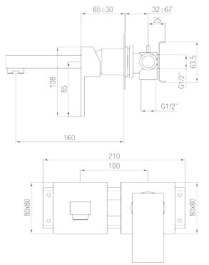
IT - Monocomando lavabo a muro connessione ponte. L 160 mm.
