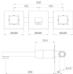
IT - Batteria lavabo a muro L 200 mm vitone ceramico.
