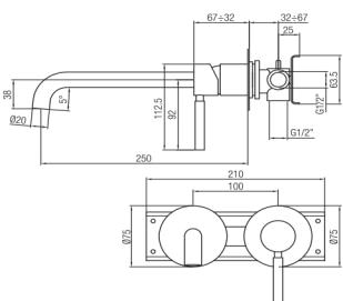
IT - Monocomando lavabo a muro connessione ponte. L 250 mm.
