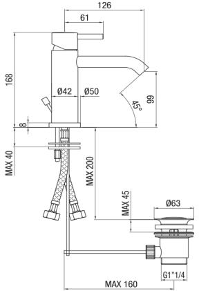
IT - Monocomando lavabo con scarico automatico.
