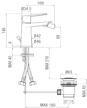
IT - Monocomando bidet con scarico automatico.
