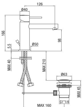
IT - Monocomando lavabo con scarico automatico.
