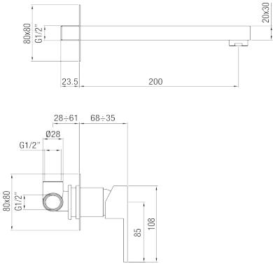
IT - Monocomando lavabo a muro due parti. L 200 mm.
