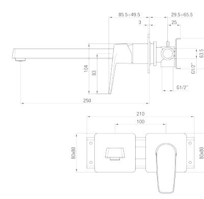
IT - Monocomando lavabo a muro due parti. L 250 mm.
