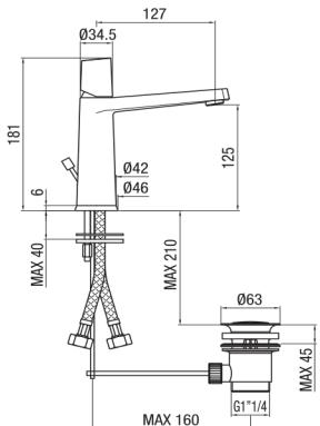
IT - Monocomando lavabo con scarico automatico.
