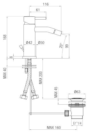
IT - Monocomando bidet con scarico automatico.
