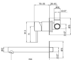
IT - Monocomando lavabo a muro due parti. L 250 mm.
