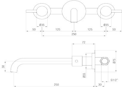
IT - Batteria lavabo a muro L 250 mm vitone ceramico.
