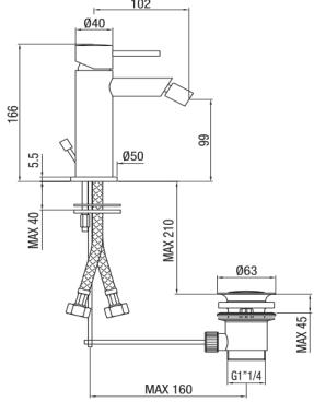
IT - Monocomando bidet con scarico automatico.
