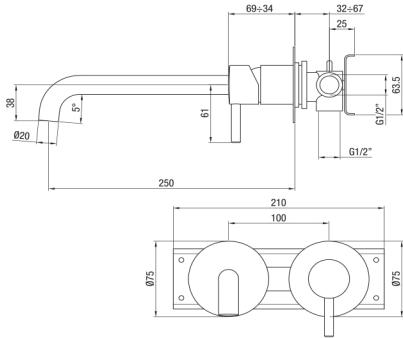
IT - Monocomando lavabo a muro connessione ponte. L 250 mm.
