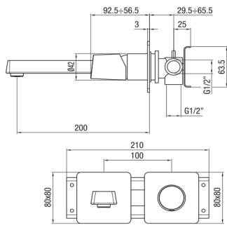
IT - Monocomando lavabo a muro connectione ponte. L 200 mm.
