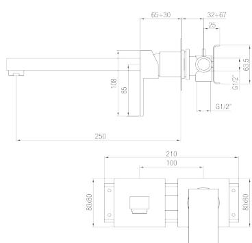
IT - Monocomando lavabo a muro connessione ponte. L 250 mm.
