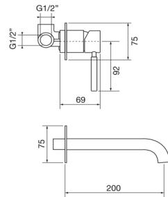
IT - Monocomando lavabo a muro due parti. L 200 mm.
