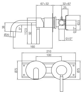
IT - Monocomando lavabo a muro connessione ponte. L 160 mm.
