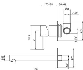
IT - Monocomando lavabo a muro due parti. L 160 mm.
