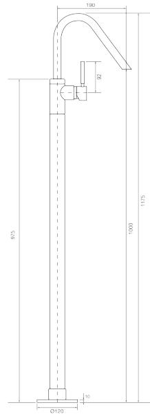
IT - Monocomando lavabo a pavimento senza scarico.
