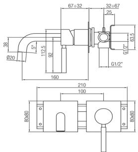
IT - Monocomando lavabo a muro connessione ponte. L 160 mm piastra quadrata.
