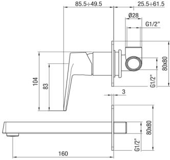
IT - Monocomando lavabo a muro due parti. L 160 mm.
