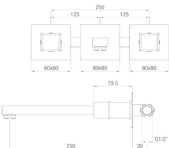
IT - Batteria lavabo a muro L 250 mm vitone ceramico.
