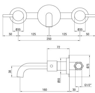
IT - Batteria lavabo a muro L 160 mm vitone ceramico.
