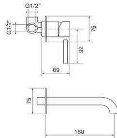
IT - Monocomando lavabo a muro due parti. L 160 mm.
