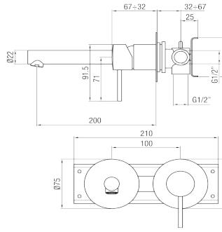
IT - Monocomando lavabo a muro connessione ponte. L 200 mm.
