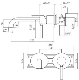
IT - Monocomando lavabo a muro connessione ponte. L 200 mm.
