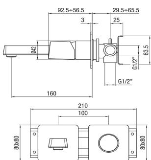
IT - Monocomando lavabo a muro connessione ponte. L 160 mm.
