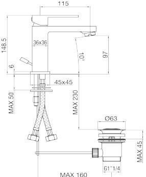
IT - Monocomando lavabo con scarico automatico.
