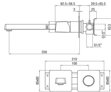
IT - Monocomando lavabo a muro connectione ponte. L 250 mm.
