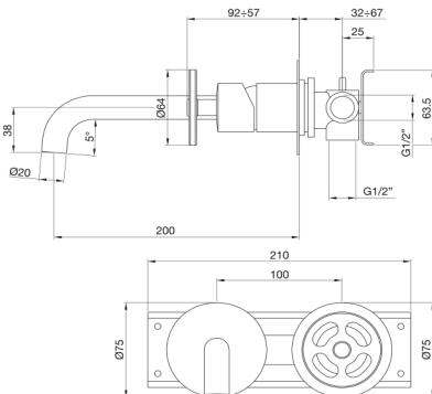
IT - Monocomando lavabo a muro conessione ponte. L 200 mm.
