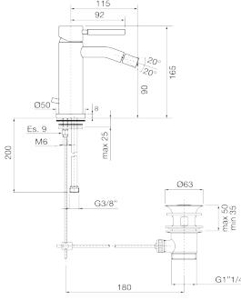
IT - Monocomando bidet con scarico automatico.
