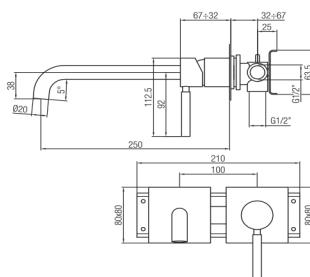
IT - Monocomando lavabo a muro connessione ponte. L 250 mm piastra quadrata.
