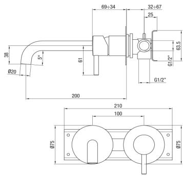
IT - Monocomando lavabo a muro connessione ponte. L 200 mm.
