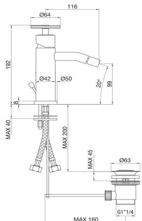
IT - Monocomando bidet con scarico automatico.
