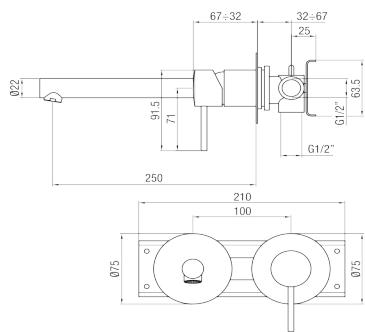
IT - Monocomando lavabo a muro connessione ponte. L 250 mm.
