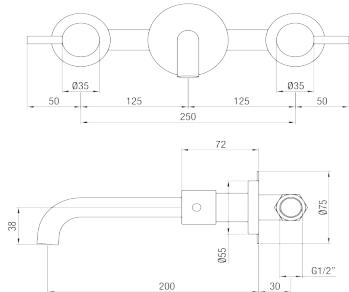
IT - Batteria lavabo a muro L 200 mm vitone ceramico.
