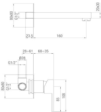
IT - Monocomando lavabo a muro due parti. L 160 mm.
