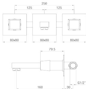
IT - Batteria lavabo a muro L 160 mm vitone ceramico.
