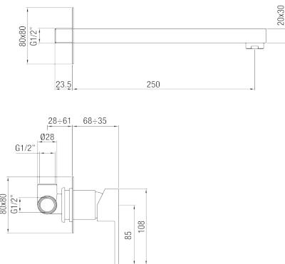
IT - Monocomando lavabo a muro due parti. L 250 mm.
