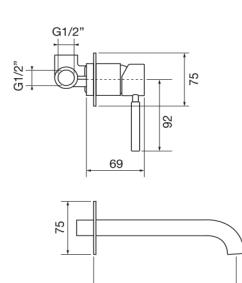
IT - Monocomando lavabo a muro due parti. L 250 mm.
