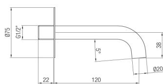
IT - Bocca d'erogazione a muro. L 120 mm.
