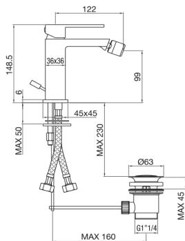
IT - Monocomando bidet con scarico automatico.
