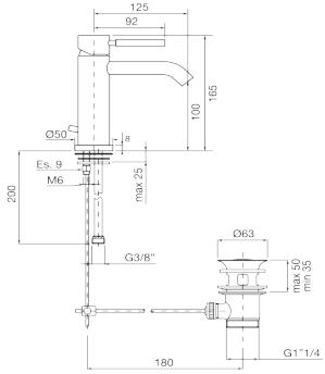
IT - Monocomando lavabo con scarico automatico.
