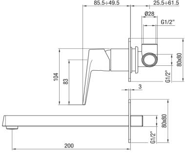
IT - Monocomando lavabo a muro due parti. L 200 mm.
