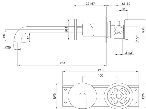
IT - Monocomando lavabo a muro connessione ponte. L 250 mm.
