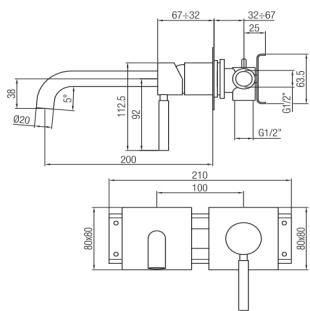
IT - Monocomando lavabo a muro connessione ponte. L 200 mm piastra quadrata.
