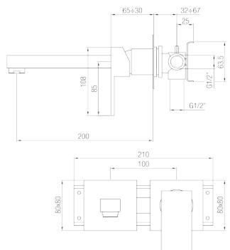
IT - Monocomando lavabo a muro connessione ponte. L 200 mm.
