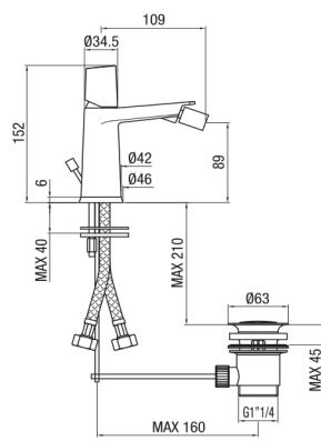
IT - Monocomando bidet con scarico automatico.
