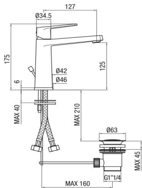
IT - Monocomando lavabo con scarico automatico.
