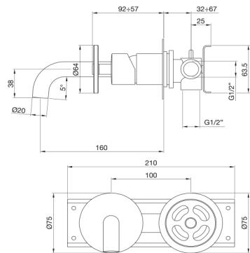
IT - Monocomando lavabo a muro conessione ponte. L 160 mm.
